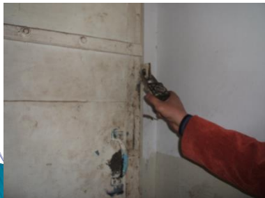
事发辐照装置的控制台（已弃用）和手摇升源装置
