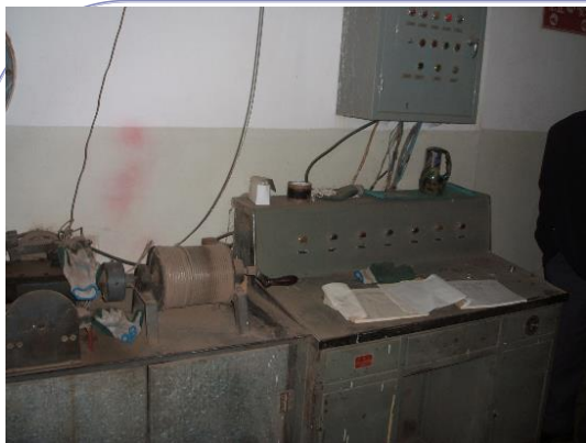
事发辐照装置的控制台（已弃用）和手摇升源装置
